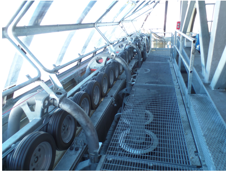
Figure 2.9 Lanceur d'un télésiège débrayable
